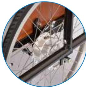
**Die Rollenbremsen** befinden sich in der Mitte des Rades und drücken die Rollen gegen den sogenannten Brems Schuh, um die Geschwindigkeit zu reduzieren. Rollenbremsen sind so ausgelegt, dass ein Überschlagen nahezu unmöglich ist.
