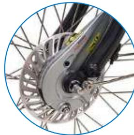
**Die Scheibenbremsen** zeichnen sich durch eine sehr starke und zuverlässige Bremsleistung aus, selbst wenn starkes Bremsen erforderlich ist. Ihre Bremskraft ist bei jedem Wetter gut, auch bei Nässe. Es gibt zwei Scheibenbremsentypen: mechanisch und hydraulisch.
