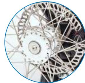
Bei einer **mechanischen Scheibenbremse** wird die am Handbremshebel ausgeübte Bremskraft über einen Seilzug auf die Bremsbeläge übertragen. Es kann vorkommen, dass sich der Seilzug ausdehnt und die Bremswirkung beeinträchtigt. Deshalb ist eine regelmäßige Überprüfung und Justierung notwendig. Im Vergleich dazu haben hydraulische Scheibenbremsen eine höhere Bremsleistung und sind wartungsärmer.
